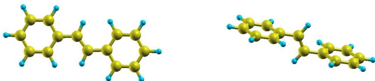
FIGURE 4.6 – Molécule de Stilbène : A gauche : géométrie plane ; à droite : géométrie présentant un angle de torsion de 90^\circ
