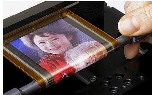
FIGURE 3.10 – A gauche : Téléviseur numérique Sony OLED XEL-1 ; à droite : Un écran souple développé par Sony
