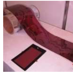
FIGURE 3.11 – A gauche : Cellule solaire à base d'un dérivé de PPV et de fullerène conçue par l'équipe de S. Sariciftci ; à droite : Film photovoltaïque organique produit par Mitsubishi Chemical.
