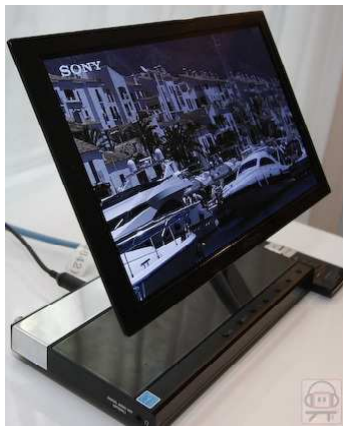
FIGURE 3.10 – A gauche : Téléviseur numérique Sony OLED XEL-1 ; à droite : Un écran souple développé par Sony
