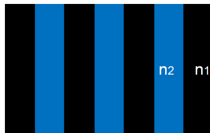
FIGURE 1.4 – Schéma d'un miroir de Bragg constitué d'un milieu diélectrique périodique unidimensionnel.
