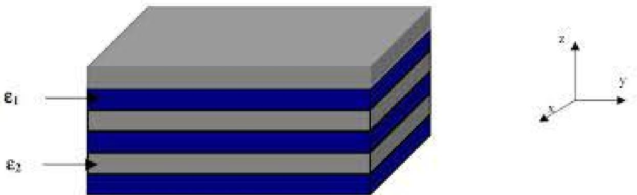
FIGURE 1.1 – Représentation d'un cristal photonique à une dimension.
